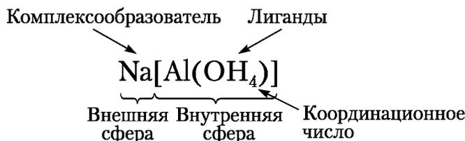
**Рис. 8.2. Комплексное соединение — тетрагидроксоалюминат натрия**
